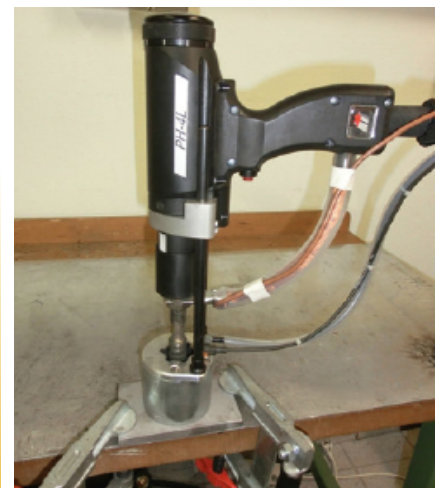
그림 4. M16 스타드용 SRM 용접 건 자장 보호가스 치구가 용접건과 헤드의 지지봉에 부착 되어 있다. 이 연결은 고정 작업으로 탈착이 쉽다.
